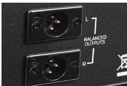
Zbalansowane wyjścia (choć nazywają się podobnie i również wykorzystują XLR-y) prowadzą sygnał w inny sposób, niż wejścia zbalansowane (dla sygnału z wkładki).
